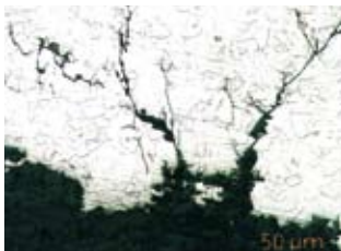
Пример транс-кристаллического коррозионного растрескивания под нагрузкой нержавеющей стали 1.4401 в среде с высокой концентрацией хлора.
