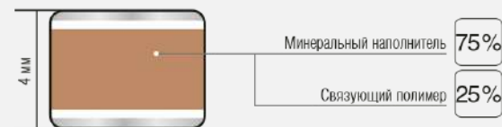
Сердечник алюминиевой композитной панели КРАСПАНКОМПОЗИТ-AL
