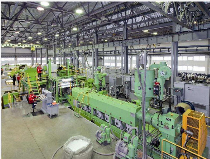
Линия по производству огнестойких композитных панелей
