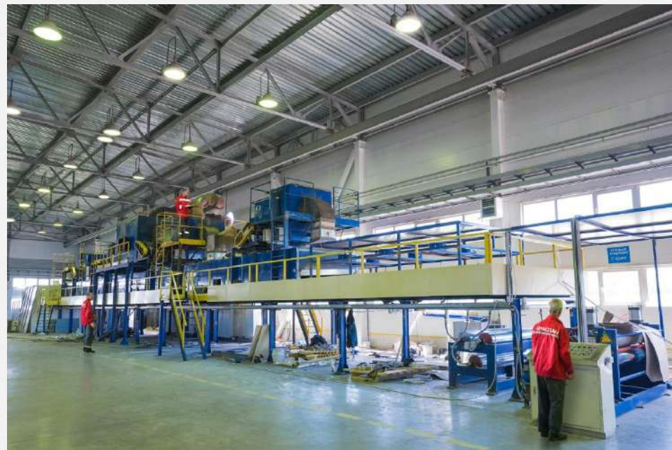
Линия по окрашиванию рулонного металла (технология coil-coating)
