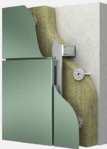
➔ U-образная подсистема Способ крепления: кассета
